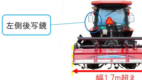
② 農耕トラクタ単体の大きさを含め、農作業機を装着した状態で幅が2.5mを超えていないか確認しましょう。幅が2.5mを超えている場合には、道路法に基づく特殊車両通行許可が必要です。
