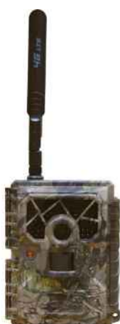
写真 2．本事業で使用した IoT カメラ（WAM キャプチャー04G）
