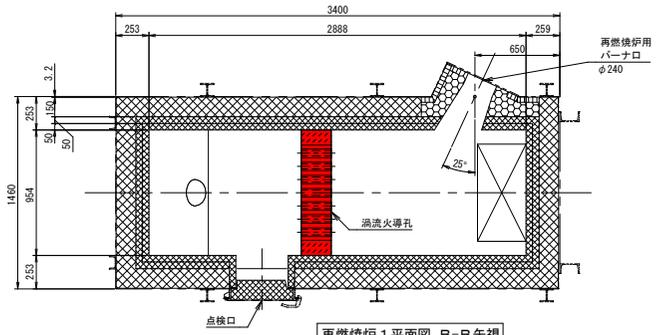
再燃焼炉 1 平面図 B-B 矢視
