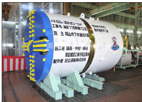
写真2-2-1 シールドマシン
