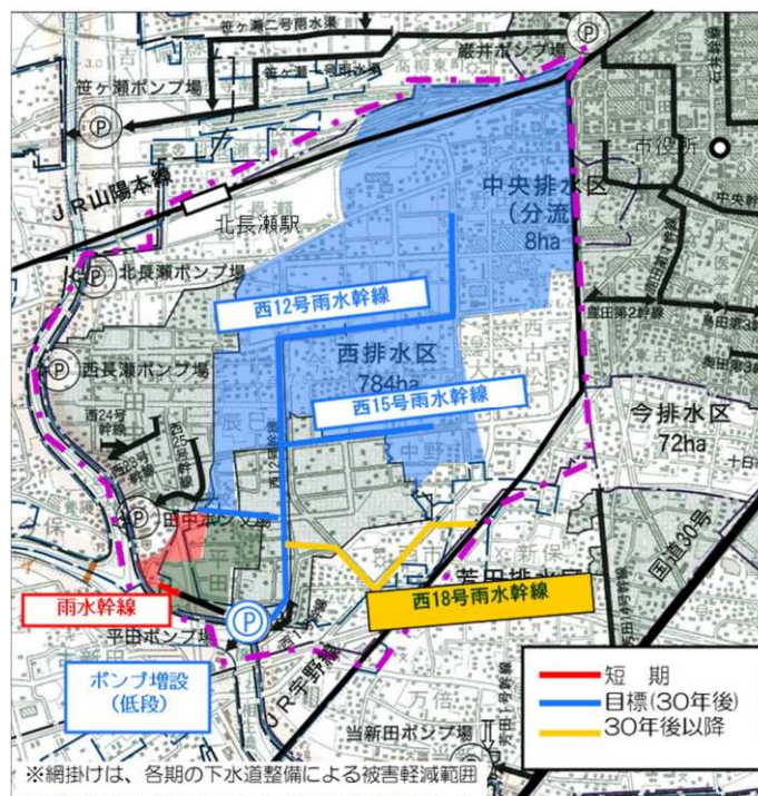
図2-2-5 西排水区浸水対策概要図
