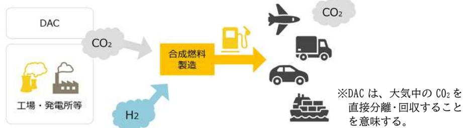
図 2-12 合成燃料の製造・利用イメージ
