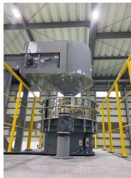
破碎された粉末は振動篩で粒度によって2種類に分けられます。
