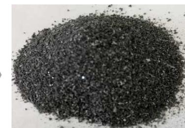
有価物の含有率が高い粒度の細かいものは精錬メーカーに売却し、銀や銅などの金属を回収します。
