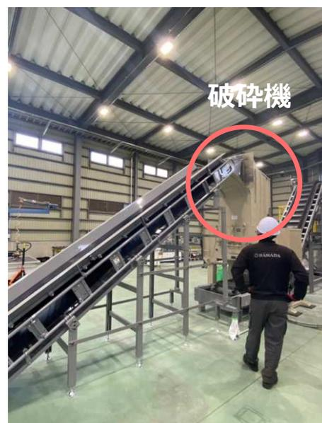
破碎機で細かく破碎します。
