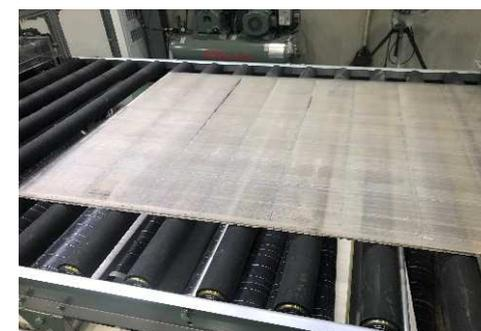
ガラスとセル/EVAシートが分離しガラスは板状のまま回収できます。セル/EVAシートはこの後、破碎・分級工程で処理されます。
