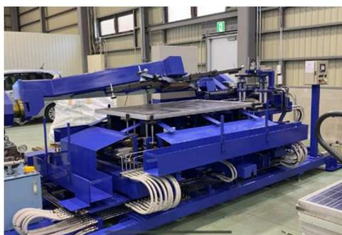
アルミフレーム除去装置にパネルをセットし、ジャンクションボックスとアルミフレームを取り外します。
