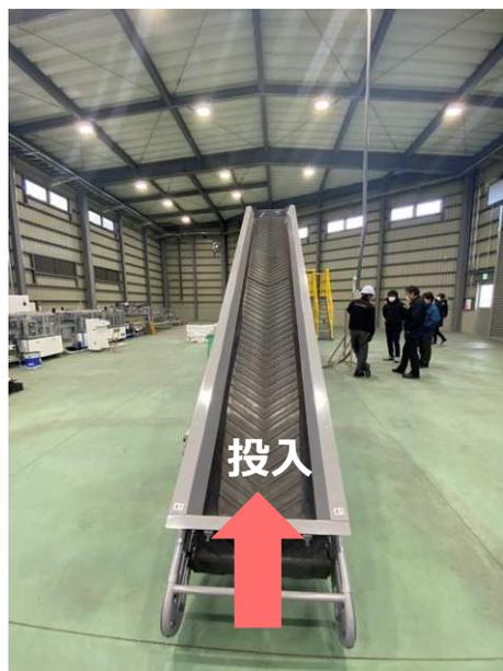
コンベアにセル/EVAシートを投入し、破碎工程へ進みます。
