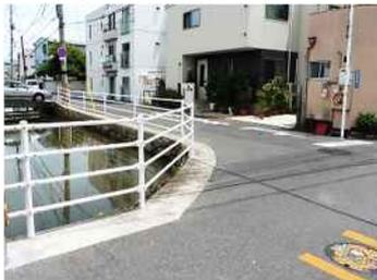
ハンプの設置による速度抑制
