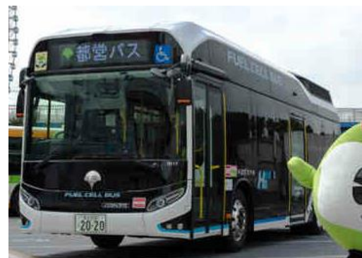
図 4-30 先進車両の例（左：自動運転車両への改造、右：燃料電池バス）
