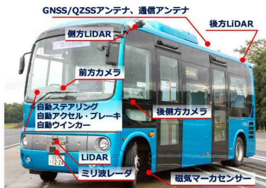
図 4-30 先進車両の例（左：自動運転車両への改造、右：燃料電池バス）
